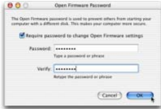
Abb. 3: Nach Eingabe des Passworts ist es für Unbefugte nicht mehr möglich, den Mac über andere startfähigen Systeme zu starten.
